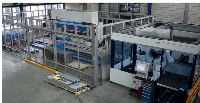
Zwei Roboter-Biegezellen für die vollautomatische Biege-/Umformbearbeitung von Blechteilen in grösseren Stückzahlen.
