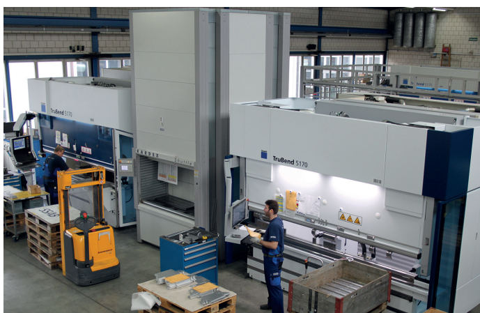
Zwei von den insgesamt elf CNC-Biegeanlagen von Trumpf.
