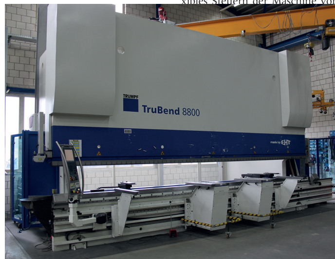
Die grösste CNC-Biegemaschine Trumpf TruBend 8800 EHT mit einer Biegelänge zwischen den Ständern von 7050 mm und mit einer Presskräften bis 8800 kN.
