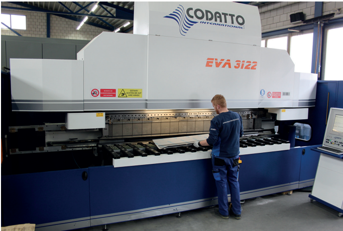
Das CNC-Universal-Biegezentrum EVA 3122 von Codatto (heute zur Trumpf-Gruppe gehörend) für die kombinierte Abkant-/Schwenkbiegebearbeitung anspruchsvoller Blechteile.
