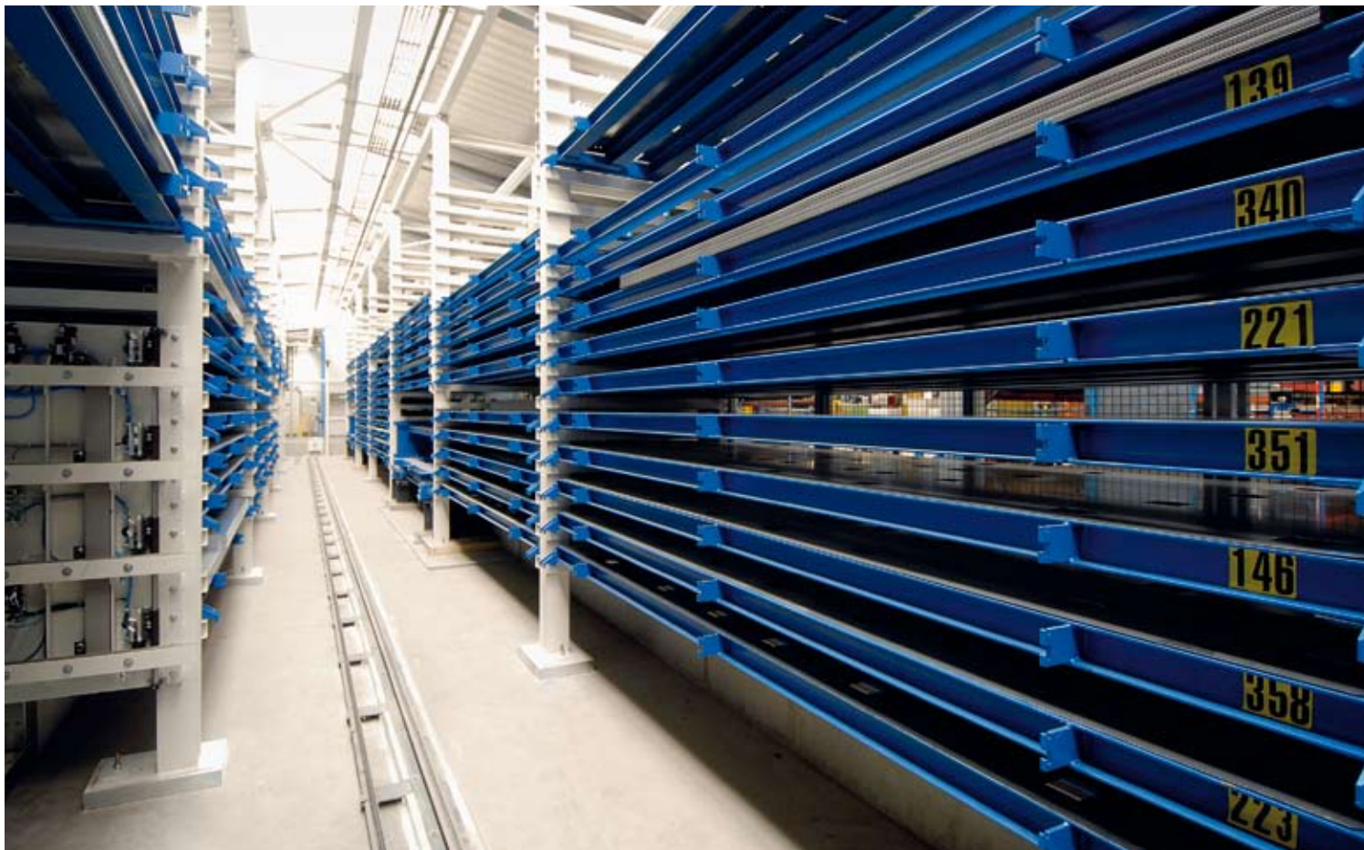
Das automatische Blechlager in der Hallenmitte beim Bellheimer Metallwerk dient zugleich als Durchgangsstation für Zwischenprodukte auf dem Weg zu den Stanzen.
