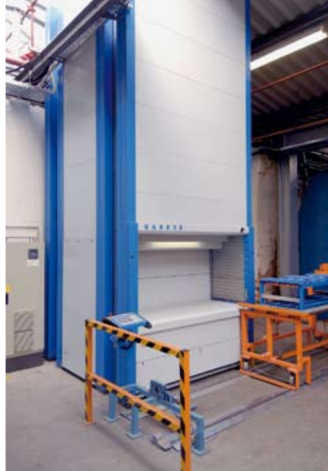
Bellheim und die Kardex Gruppe fertigen Roll- und Umlaufregale (rechts). Im eigenen Unternehmen dienen sie als Werkzeugschrank: Ludwig Stahl gibt einen Code für die anstehende Baugruppe ein und erhält eine Schublade mit allen Werkzeugen, die er dafür braucht (siehe Kasten).
