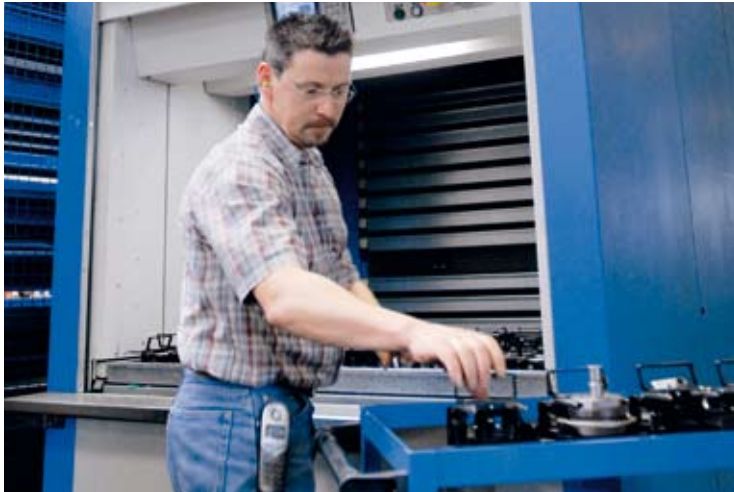
Bellheim und die Kardex Gruppe fertigen Roll- und Umlaufregale (rechts). Im eigenen Unternehmen dienen sie als Werkzeugschrank: Ludwig Stahl gibt einen Code für die anstehende Baugruppe ein und erhält eine Schublade mit allen Werkzeugen, die er dafür braucht (siehe Kasten).
