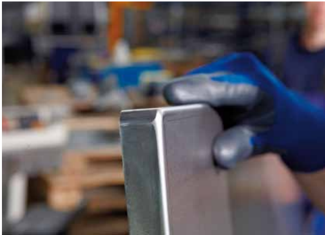
Eine von mehreren Spezialitäten von Meyer Blech Technik AG ist das automatische Eckenformen.
